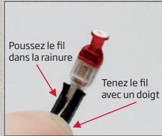
2. Placez l'écouteur dans l'outil et poussez le fil dans la rainure pour obtenir une fixation stable. Tenez le fil avec un doigt.
